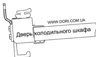
Рис. 3. Схема установки замка (вид сверху)
